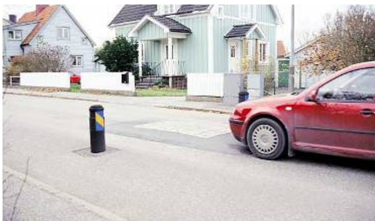
Bild 4.1: Exempel på väggkudde kombinerat med avsmalning av vägen i form av två stolpar.
